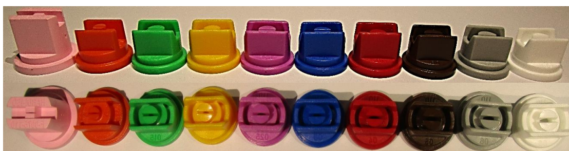
شکل ۱ نازل‌های بادبزی استاندارد ۱۱۰ درجه‌ای مورد استفاده (نازل شماره ۱۱۰۰۷۵ (صورتی)، نازل شماره ۱۱۰۰۱ (نارنجی)). در فشار ۳ بار، قطر قطرات برای شماره نازل‌های ۱۱۰۰۷۵ الی ۱۱۰۰۱۵ (سبز) بین ۶۱ تا ۱۰۵ میکرومتر، برای شماره نازل‌های ۱۱۰۰۲ (زرد) الی ۱۱۰۰۵ (قهوه‌ای) بین ۱۰۶ تا ۲۳۵ میکرومتر و برای شماره نازل‌های ۱۱۰۰۶ (طوسی) و ۱۱۰۰۸ (سفید) بین ۲۳۶ تا ۳۴۰ میکرومتر
