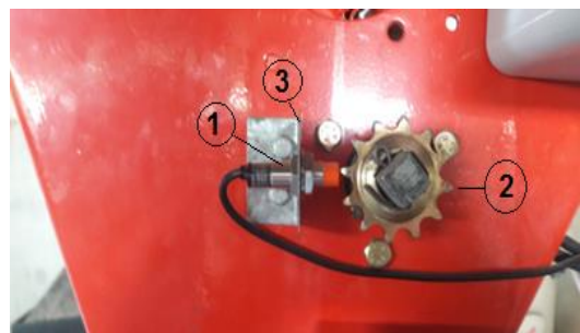
شکل ۲ محل قرارگیری حسگر موقعیت دریچه و اجزا آن در دستگاه فاروئر-کودکار چهار ردیفه با سامانه کنترلی ابداعی، شامل: ۱- موزع ۲- حسگر ۳- دریچه موزع
