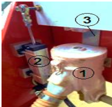
شکل ۳ مجموعه حسگر سرعت پیشروی در دستگاه فاروئر-کودکار چهار ردیفه با سامانه کنترلی ابداعی، شامل ۱- حسگر ۲- چرخ زنجیر ۳- پایه حسگر Fig. 3. The machine traveling speed sensor unit in the four-row furrow-fertilizer applicator with the invented controlling system includes: 1- Sensor 2- Sprocket wheel 3- Sensor holder
