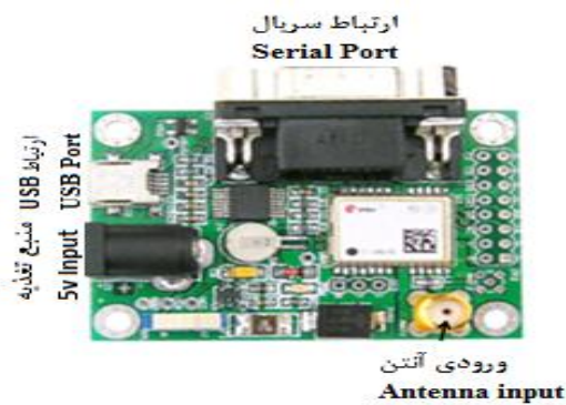
شکل ۶ ماژول گیرنده GPS در دستگاه فاروئر-کودکار چهار ردیفه با سامانه کنترلی ابداعی
