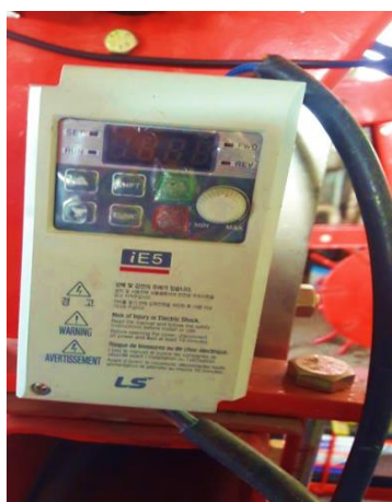
شکل ۹ تصویر اینورتر الکتروموتور محرک چرخ زمین‌گرد در ارزیابی
