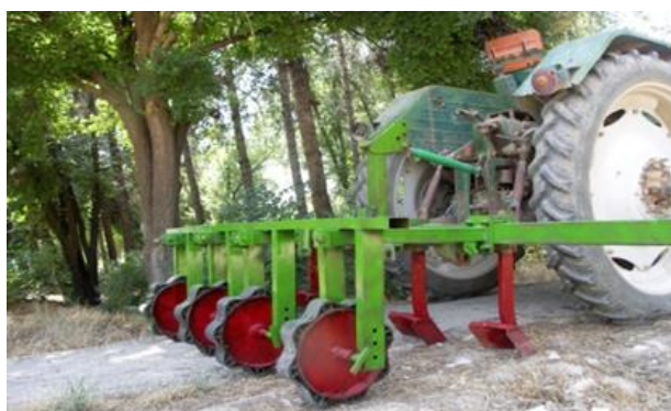
شکل ۱ دستگاه فشرده‌کننده‌ی سطحی خاک با چرخ لاستیکی
