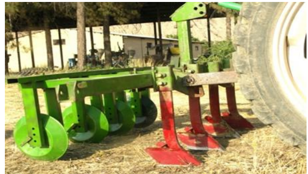
شکل ۲ دستگاه فشردننده‌ی سطحی خاک با چرخ فلزی
