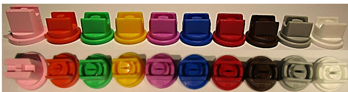
شکل ۱ نازل‌های بادبزی استاندارد ۱۱۰ درجه‌ای مورد استفاده (نازل شماره ۱۱۰۰۷۵ (صورتی)، نازل شماره ۱۱۰۰۱ (نارنجی)). در فشار ۳ بار، قطر قطرات برای شماره نازل‌های ۱۱۰۰۷۵ الی ۱۱۰۰۱۵ (سبز) بین ۶۱ تا ۱۰۵ میکرومتر، برای شماره نازل‌های ۱۱۰۰۲ (زرد) الی ۱۱۰۰۵ (قهوه‌ای) بین ۱۰۶ تا ۲۳۵ میکرومتر و برای شماره نازل‌های ۱۱۰۰۶ (طوسی) و ۱۱۰۰۸ (سفید) بین ۲۳۶ تا ۳۴۰ میکرومتر
